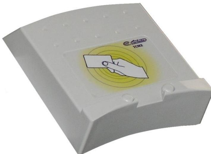
Le lecteur **Cartadis TCM2** est un lecteur de cartes sans contact ou de proximité, compatible avec la grande majorité des cartes du marché en technologie 13.56 Mhz et 125 Khz. Par défaut, il émule un clavier USB et ne nécessite donc pas l'installation de pilote sur les PC Windows.
